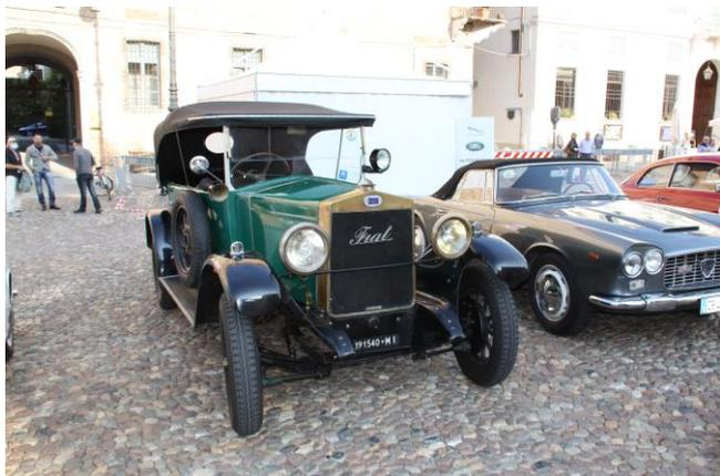
Splendida vettura Fiat del 1926 quasi totalmente conservata. Il modello sostituì il precedente Fiat 502, montava un motore 4 cilindri di 1467 cc ed aveva una potenza di ben 27 CV a 3000 giri al minuto, cambio a 4 rapporti ed una velocità massima di 72,54 Km/orari.
